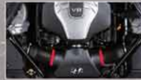
محرك GDI V6 سعة 3.8 لتر 315 حصان متوفر بمحرك GDI V8 سعة 5.0 لتر بقوة 413 حصان
